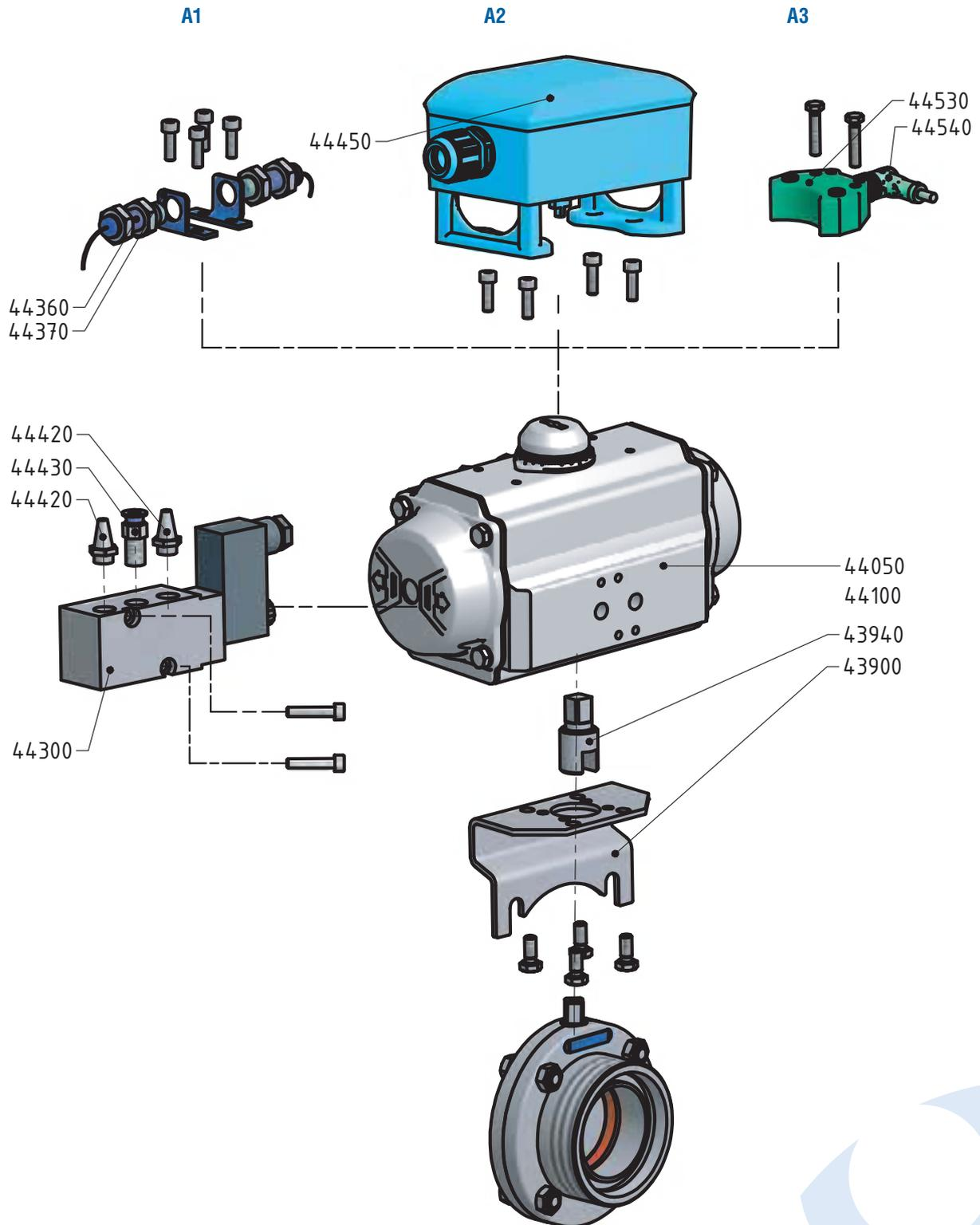
**ЗАТВОР ДИСКОВЫЙ С ПНЕВМОПРИВОДОМ 44160, 44210**
