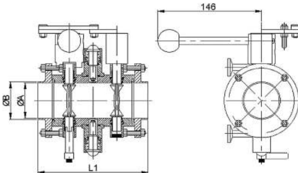
**ЗАТВОР С КОНТРОЛЕМ ПРОТЕЧКИ ДВУХДИСКОВЫЙ МЕЖФЛАНЦЕВЫЙ**
