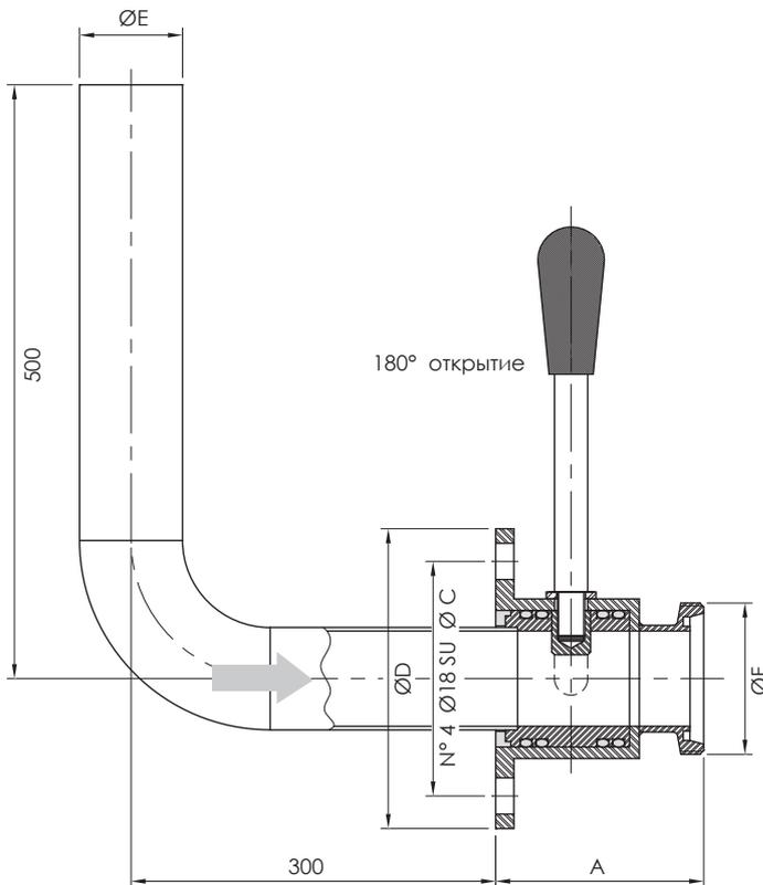
**ДЕКАНТАТОР 90° ФЛАНЕЦ-ФЛАНЕЦ КВАДРАТНЫЙ**
